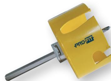
Bohrdurchmesser 108/121 mm, Spannschaft: Ø 13 mm, Schnitttiefe: ca. 58 mm
