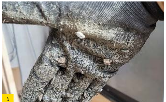
6 Eine ausreichende Durchmischung hat stattgefunden, wenn einzelnen Splittkörner am Handschuh haften bleiben.
