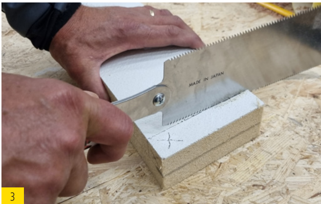
3 Mit einer Handsäge markiertes aussägen.
