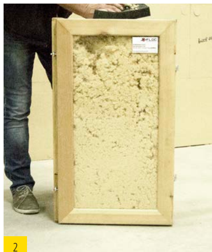
2 Verdichtetes Einblasen mit Schlauch
