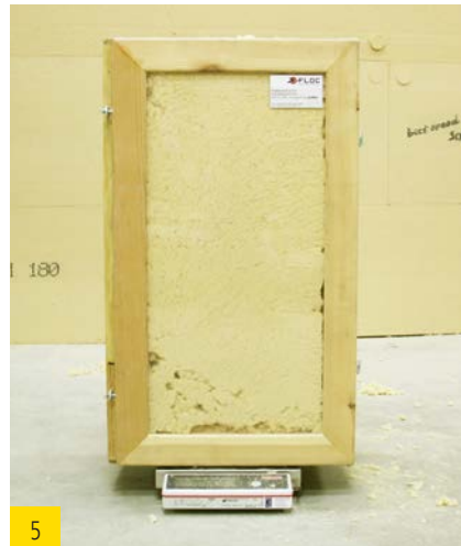
5 Befülltes Prüfelement erneut wiegen
