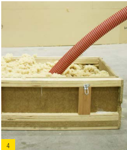
4 Offenes Aufblasen mit Schlauch
