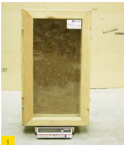
1 Leeres Prüfelement wiegen
