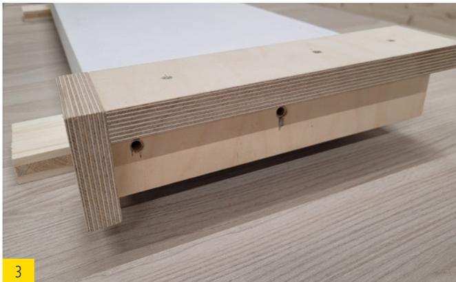
3 Montagehilfe an der Unterkante der STURZBLENDE ansetzen.
