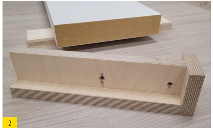
2 Eine Montagehilfe zur genauen Positionierung der Buche-Holzdübel wird empfohlen.
