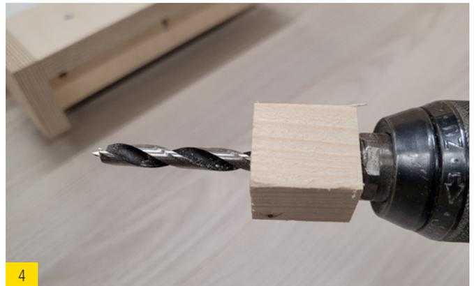
4 Tiefenbegrenzer für Bohrl Lochtiefe in Abhängigkeit der Materialstärke der Montagehilfe. Das Bohrloch muss 22 mm tief sein.
