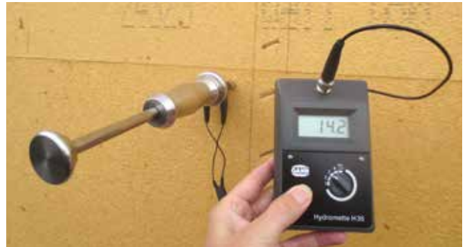
Plattenfeuchte \leq 19,5 % mit Einstellung Fichte/Kiefer.
