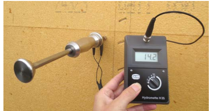
Plattenfeuchte \leq 19,5 % mit Einstellung Fichte/Kiefer.
