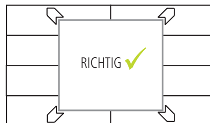
Keine Plattenstöße an Öffnungsecken!
