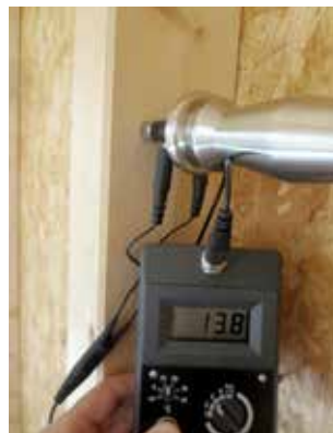
Holzfeuchte Holzständerkonstruktion \leq 18\% .
