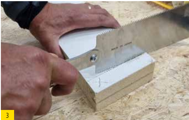
3 Mit einer Handsäge markiertes aussägen.
