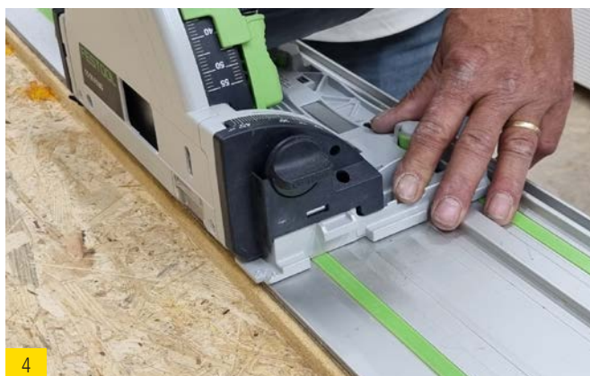
4 Den Dichtkeil und die beiden Dichtecken an der vorderen Kante auf die gewünschte Tiefe absägen.
