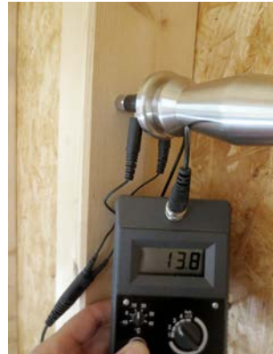
Holzfeuchte Holzständerkonstruktion \leq 18\% .
