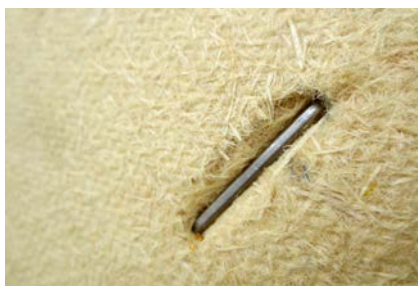
Edelstahl-Breitrückensklammer ca. 1 mm in der best wood WALL 180 vertieft.
