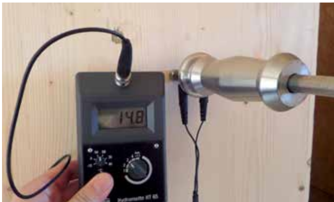
Holzfeuchte Holzständerkonstruktion \leq 18\% .
