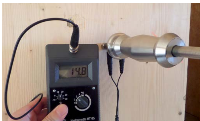
Holzfeuchte Holzständerkonstruktion \leq 18\% .
