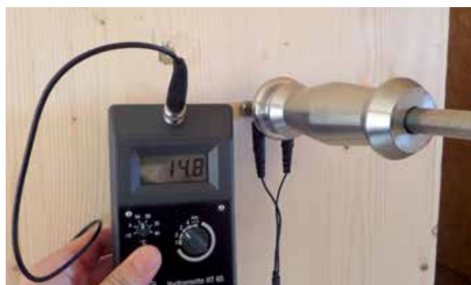
Humidité d'une construction d'ossature bois \leq 18\% .
