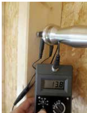
Humidité d'une construction d'ossature bois \leq 18\% .
