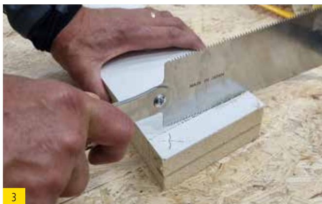
3 Découper ce qui est marqué avec une scie à main.
