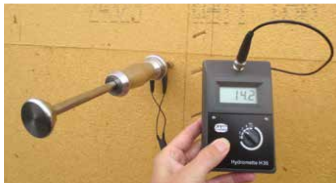
Humidité des panneaux \leq 19,5\% avec réglage épicéa/sapin.
