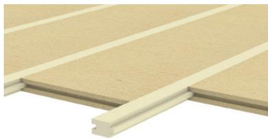
Panneau isolant semi-rigide avec lisse en bois pour la fixation des planchers bois, garantissant une bonne isolation phonique. Posé sans lisse en bois comme sous-couche pour les systèmes flottants de chapes sèches, parquets ou chapes à base de ciment. Les lisses en bois sont à rainures et languettes.
